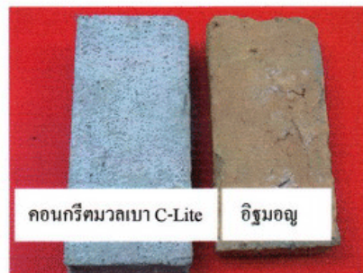
รูปที่ 1 แสดงลักษณะคอนกรีตมวลเบา C-Lite และอิฐมอญที่ใช้ในการทดสอบ
